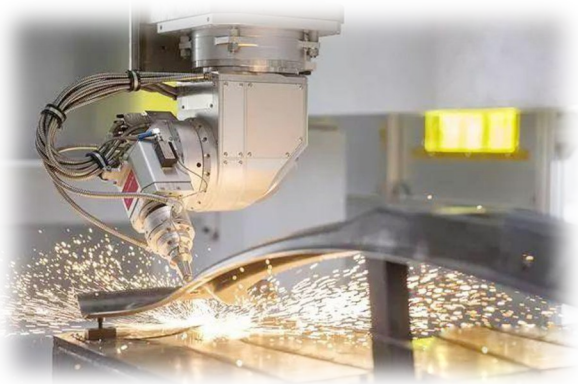
▲华工科技研发的三维五轴激光切割装备
